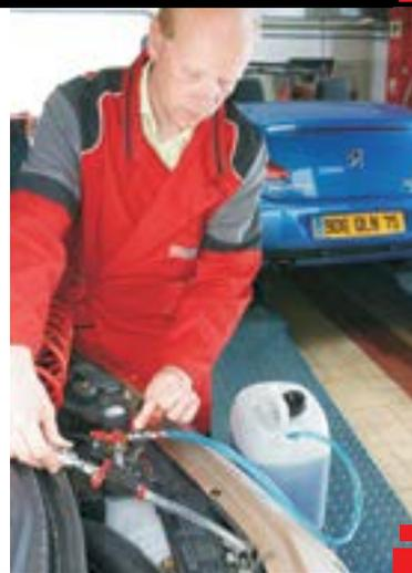
935A Оборудование для заполнения систем охлаждения путем декомпрессии
